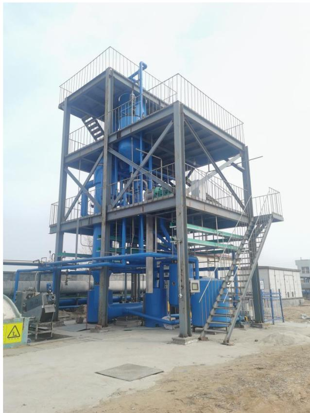
图 4-2 MVR 蒸盐预处理装置
